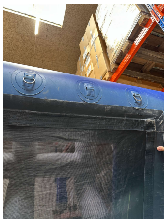
Manglende D-ring på Vista modul skal monteres.
