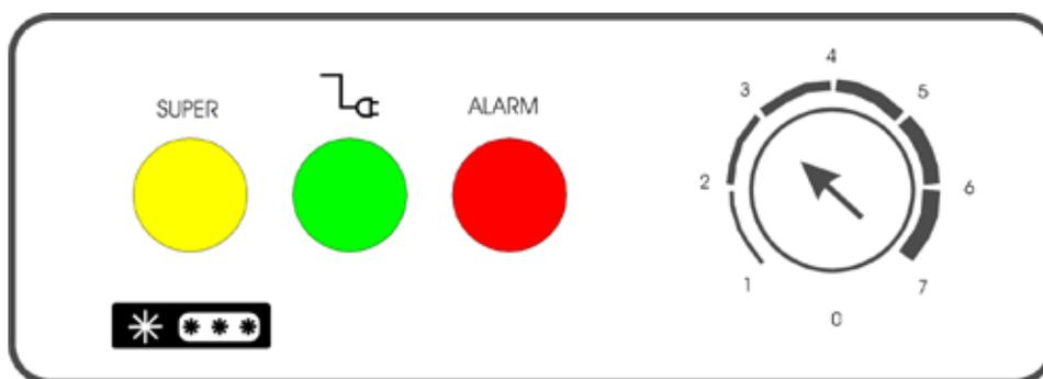
Le thermostat est réglable de 1 à 7, ce qui correspond à environ  $-15^{\circ}$  à  $-25^{\circ}\text{C}$ .
