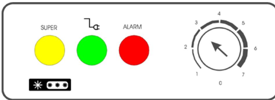
El termostato se puede regular en una escala del 1 al 6, que equivale a entre -15 y -25°C
