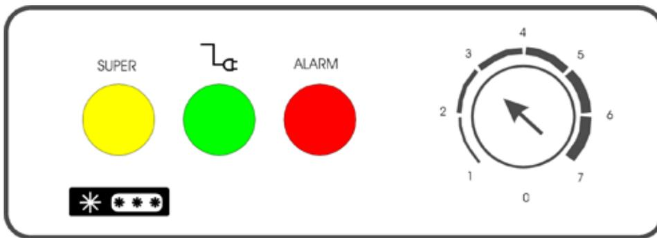
Der Thermostat kann auf eine Skala von 1-7 eingestellt werden, das entspricht ca. -15 bis -25°C. Eine Einstellung auf 3-4 ist in den meisten Fällen das Optimale. Das Kühlsystem kann abgeschaltet werden, indem Sie auf Stellung 0 drehen.
