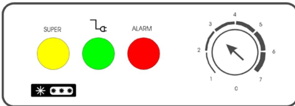
Termostaten kan indstilles på en skala fra 1-7, hvilket svarer til ca. -15 til -25 °C. En indstilling på 3-4 vil i de fleste tilfælde være optimal. Kølesystemet kan frakobles ved en indstilling på 0.
