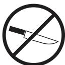
1. O equipamento, embora equipado com programador automático de descongelações, deverá ser desligado e limpo (ver capítulo limpeza) pelo menos uma vez por mês. **A acumulação de gelo no evaporador reduz a performance e faz aumentar os custos energéticos. Nunca remover o gelo com espátulas, facas ou outros objectos metálicos. O procedimento ideal é deixar descongelar o evaporador naturalmente.**
