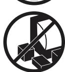
6. Le groupe de condensation (compresseur + condenseur), généralement installé sur la partie inférieure de l'appareil, ne doit pas être entouré par quelconque obstacle qui puisse réduire la libre circulation de l'air. Ainsi, les boîtes et autres objets ne doivent pas être situés près des zones de circulation d'air.
