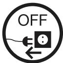
2. Antes de efectuar qualquer limpeza ou intervenção de manutenção desligue o equipamento da alimentação eléctrica, retirando a ficha da tomada de corrente, de forma a garantir que não haja qualquer tipo de corrente eléctrica a ele associado. De seguida retirar todos os produtos do seu interior para uma câmara frigorífica adequada.
