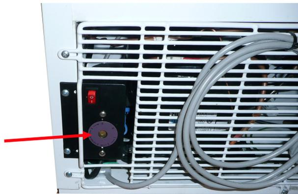
Das Thermostat kann von -12 bis -24 °C eingestellt werden. In den meisten Fällen ist eine Einstellung auf Position 5 optimal. Die Temperatur wird beim Drehen vom Thermostat im Uhrzeigersinn gesenkt und wird beim Drehen gegen den Uhrzeigersinn erhöht.
