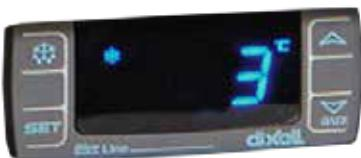
Le thermostat a été préréglé et dans la plupart des cas, il n'est pas nécessaire d'ajuster les réglages.
