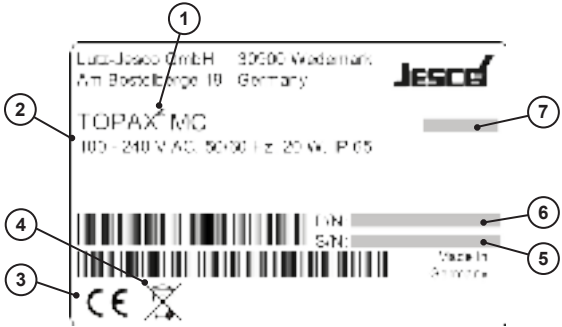
Figur 6: Typebetegnelse flerkanaals regulator TOPAX® MC
