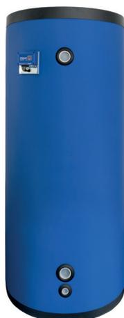
Der EC POWER-Wärmespeicher mit externer Storage Control stellt sicher, dass die in der XRGi®-Anlage produzierte Wärme gespeichert wird, wenn zeitgleich eine geringere oder keine Abnahme der Wärme durch den Verbraucher stattfindet. Somit wird ein Takten der XRGi®-Anlage verhindert und der XRGi®-Betrieb wird mit langen Laufzeiten nach einem Start effektiver.
