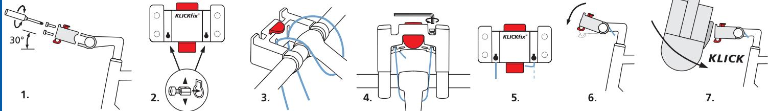
**1. Gehäuse montieren** Beide Kunststoffbügel auf den Lenker aufrasten. Das Gehäuse auf die Kunststoffbügel schieben. Schrauben in Gehäusevorderseite einstecken und leicht anspannen. Der Adapter muß dabei schräg nach oben ausgerichtet sein.
